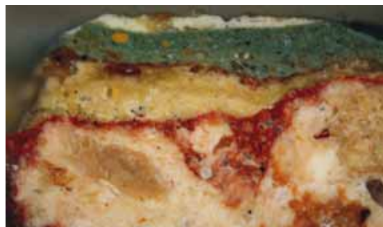
Abb. 07 Probe Nr. 24, Südöstlicher Bündelpfeiler des Querhauses (Abb. 09). Deutlich zu erkennende Farbschichten, Rot, Ocker, Grün, Weiß auf Kalkstein. Anschliff, Polarisiertes Licht.
