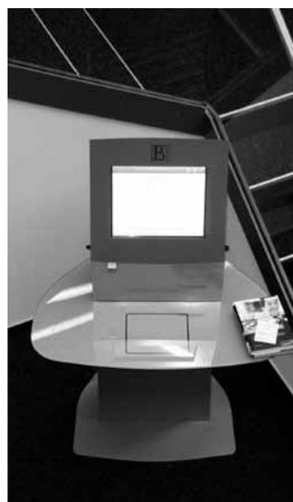
Eines der beiden RFID-gestützten Selbstverbucher-Terminals
