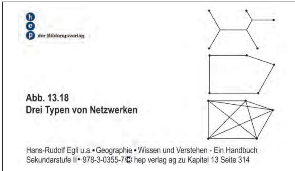
Abb. 4: Drei Typen von Netzwerken: Zuerst baukostenoptimiertes Netzwerk, in der Mitte ein Kettennetzwerk (»Route des Handelsreisenden«), unten benutzeroptimiertes Netzwerk
