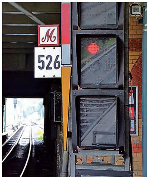
Abb. 1: M-Tafel an einem Lichthauptsignal (Ks-Signal) bei der Berliner S-Bahn, S-Bahnhof Schönhauser Allee, Westkopf, 2018
