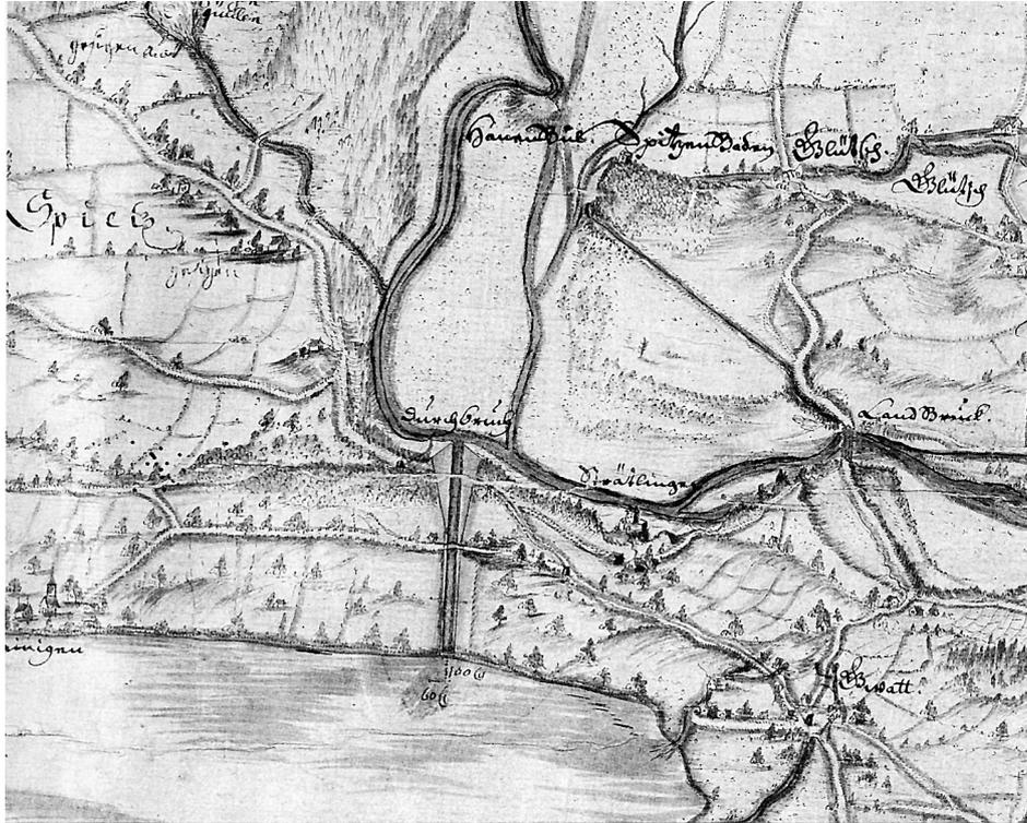
Abb. 63 Ausschnitt aus dem Plan von S. Bodmer von 1710 für die Kanderumleitung. Oben der alte Kanderlauf südlich des Thunersees, in der Bildmitte der Durchbruch (Durchbruch) durch den Strättligenhügel.
