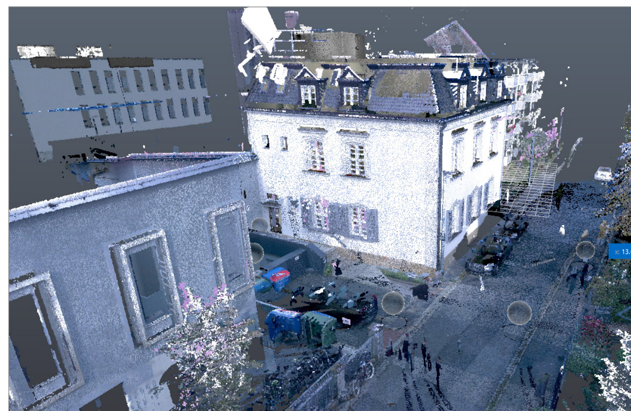
Punktwolke eines 360° Scanners für H-BIM (Historic Building Information Modelling)
