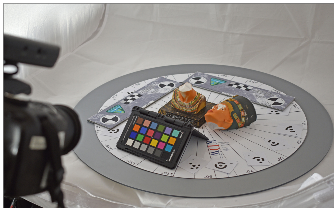
Systematische Fotografie für Structure from Motion/ Photogrammetrie 3D-Modelle
