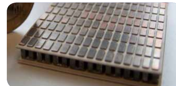
Thermogeneratoren wandeln Temperaturunterschiede in elektrische Spannungen um.
