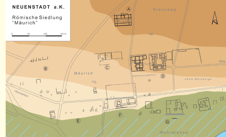
Die antike Siedlung wurde planmäßig an einem nach Süden geneigten Hang angelegt. Öffentliche Bauten nehmen markante Punkte ein. Das Zentrum bildet ein Heiliger Bezirk, der von einer Mauer umgeben ist. Die Bebauung zieht sich bis ins Flusstal, wo vermutlich ein Hafen lag.
