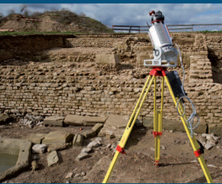
Laserscanner bei der Arbeit.
