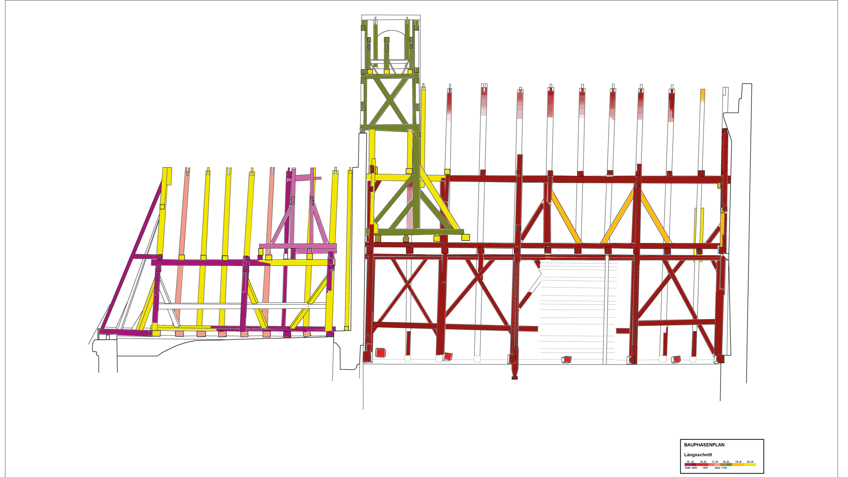
2 Längsschnitt mit Bauphasen, Besold 2014
