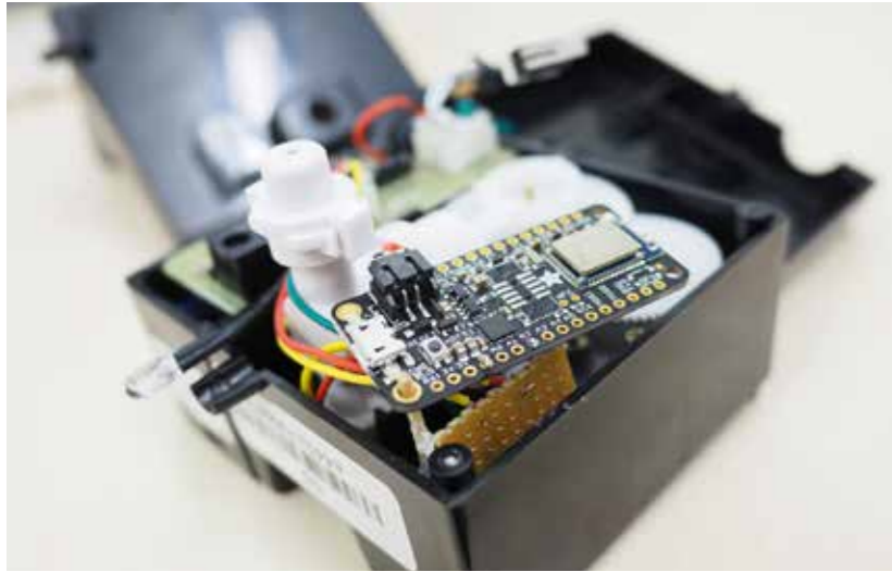
So sieht das komplexe Innenleben des smarten Seifenspenders aus, der den Seifenverbrauch misst.
